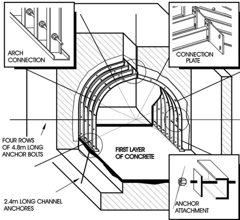
Figure 2a : Rigid Steel Arches
